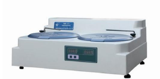
在金相试样制备过程中，试样的磨光与抛光是二项非常重要的工序，通常是采用金相试样预磨机和金相试样抛光机二种设备来完成，为适应我国工业和科技发展的需要，结合用户的使用要求，我公司新设计制造成 YMP-2B 型金相试样磨抛机。该机外形新颖美观，集污盘和罩用玻璃钢整体制成。该机经久耐用，维护保养也极为方便，使用时只需更换磨盘或抛盘，就能完成各种试样的粗磨、细磨、干磨、湿磨及抛光等各道工序，为扩大不同试样的制备要求，该机的磨、抛盘直径均大于国内同类产品。可在工作面上有更多不同线速度的选择，可增加有效工作面 20-30%，可提高试样的磨抛质量和试样的制备效率，并该机转动平稳，噪音低，是一种极为理想和功能完善的最佳金相制样设备。
