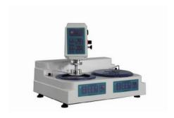
金相试样的制备过程中,试样的预磨、抛光研磨是多道必不可少的程序,本机 YMPZ-1的集污盘和罩采用吸塑整体制作,是具有外形新颖美的最新产品。本机是采用单片机结的企作或特替机,磨盘 100RFM-1400RFM 无级调速,数码管显示磨盘转速,电机为直流无刷电机,电机无需更换电刷,使用时间长,机台吸塑烤漆,无毒性,牢固的大型支撑底盘设计确保了精密的回转平衡度,强大的电机扭力带来强大的动力,带来高效的研磨抛光体验,主轴防漏设计,确保了几乎不会损坏的轴承,超级静音的设计带来良好的使用体验,全系列支持快速换盘系统,使用弹性佳,搭配自动研磨装置,能代替手工进行磨抛的各道工序,可定时,设定磨头转速。可提高试样的磨抛质量和制作效率。是比较理想的金相制样设备。
