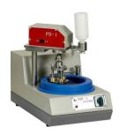
MP-1 型单盘双速磨抛机是集预磨、抛光、研磨于一机只须更换磨抛盘等就能进行预磨、抛光或研磨工作,该机转动平稳噪音低、变速与更换磨抛盘也极为方便,磨抛盘直径也均大于国内同类产品,可增加有效工作面 20-30%,并可安装 PD-1 抛光器进行自动抛光,可一机多用,是金相制样设备的最佳选择,本机的基本转速为 500/1000r/min,并备有 400/800r/min,300/600r/min,200/400r/min,供用户选择订购。
