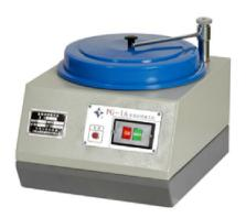
在金相试样制备过程中,试样的抛光是一道主要工序,经过磨光的试样,在抛光机上抛光后,可获得光亮如镜的表面,PG-1A 抛光机是采集多方面使用人员的意见和要求设计而成的,它具有传动平稳、噪音小、操作维修方便等优点,该机的抛光盘直径和传递功率均大于国内同类产品,能适合更多材料的抛光要求,并装有抛光用水装置是试样抛光的极佳设备。
