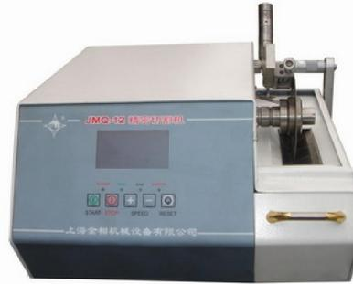
JMQ-12 型低速精密切割机，主要用来切割小型圆柱、方形金属体或电子线路板材料。该机采用砝码块负荷恒定切割力自动切割，切割完成后自动停止。采用千分尺装置，可调整试样切割的厚薄，做到精密切割，因此可作为透射电镜的配套制样设备。JMQ-12 型低速精密切割机转速可控。为避免在切割中因过热而烧伤试样，该机配有强冷却系统，在切割过程中金刚石切割片转动带出冷却水，使切割片和试样材料得到冷却，切割后的试样表面光亮、平整，无烧伤。该设备具有操作使用和维护保养方便等特点，是切割小型材料和电子线路板的极佳设备。
