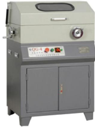
QG-4 型多能切割机，主要是用来切割圆柱体和多角形及有凸凹等不规则型材的试样，该机是采用全封闭结构，可保证在绝对安全的状态下进行切取试样，为避免在切割中试样因过热而烧伤材料组织，该机除配有强冷却系统外，并在切割时试样可旋转，可避免试样在切落时表面的微烧伤，可增大切割截面，提高切割砂轮的利用率，具有操作使用维护保养方便等优点，是切割不规则型材的极佳设备。
