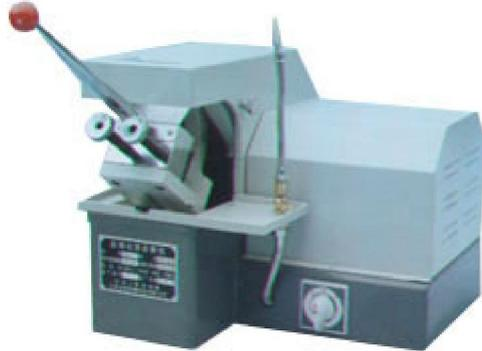
QG-1 型金相试样切割机是金相试样的首道工序，本机是采用高速旋转的薄片增强砂轮来截取试样，为不使在切割中烧伤试样的组织，本机装有冷却系统。它广泛应用于各金相实验室，切割各种金相试样。本机操作使用，维护保养极为方便，并均优于国内同类产品。
